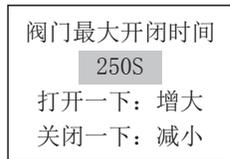
此时，可用操作旋钮或遥控器设置最大开闭时间。阀门最大开闭时间可在“10S~250S~不限时”之间设置。当连续开阀或连续关阀时间超过此设置时间时，停机报故障。此功能可对阀门卡死、齿轮松脱、电机堵转起到一定的保护作用。
