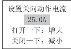
利用操作旋钮或遥控器调整电流值后再返回到停止位置，完成设置。关向动作电流设置完成后，在关阀过程中，检测到当前电机电流超出动作电流值0.5秒以上即停机报警。
