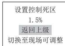
将位置旋钮切换到现场位置，可用操作旋钮或遥控器调整死区数值。
